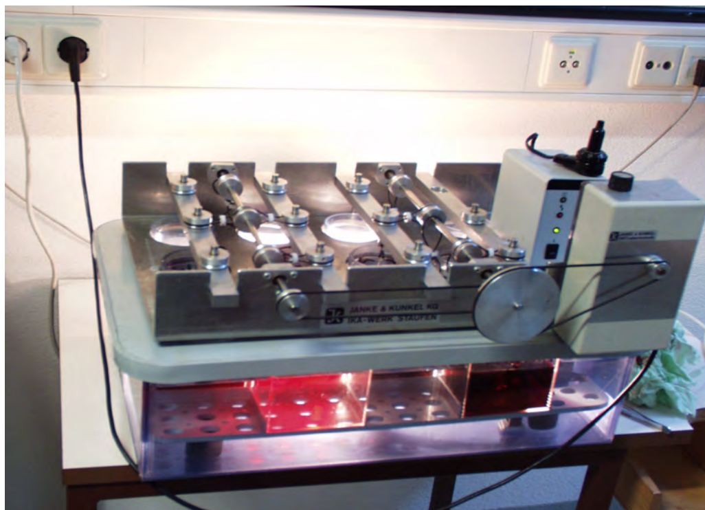
Abb. 3: Züchtungsapparatur mit der Möglichkeit in 11 Gefäßen gleichzeitig je 4 Kristalle bei konstanter Temperatur nach der Verdunstungsmethode zu züchten. Je nach Kristallgröße dauert die Formänderung vom Oktaeder zum Würfel zwischen 4-12 Wochen.
